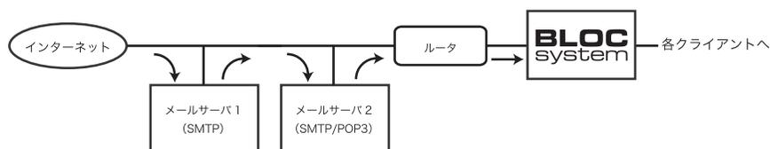
上記の経路で外部からのメールを受信し、自社内部リレーメールサーバの後ろにBLOCを導入した場合を例にとります。
